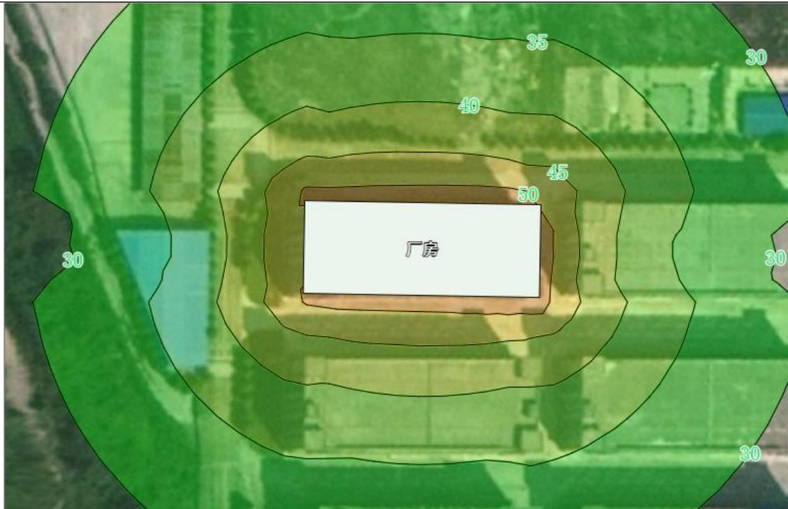
图 4-1 项目设备噪声预测值等声值线图
